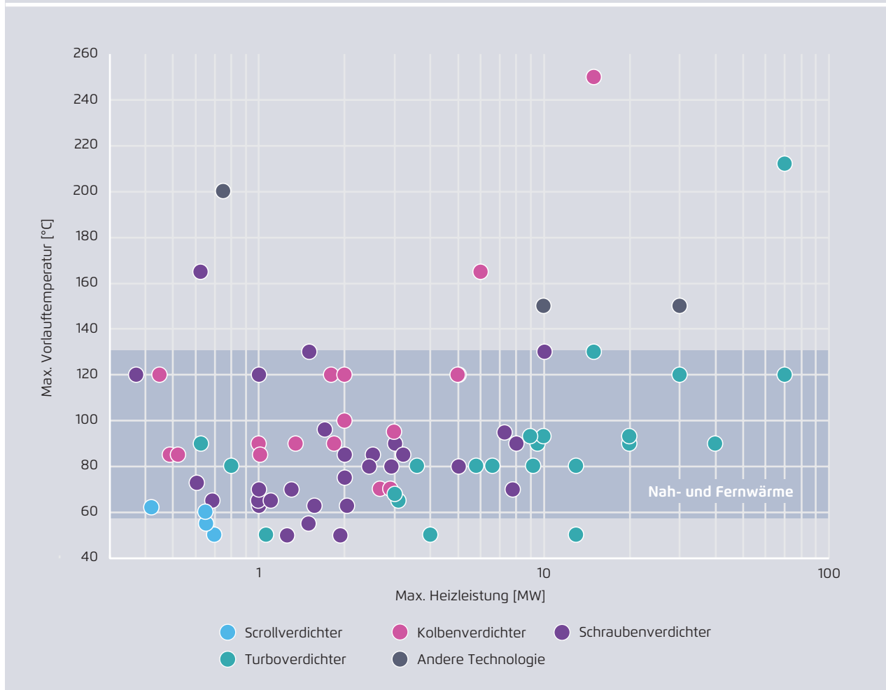
Maximale Vorlauftemperatur und Heizleistung verfügbarer Großwärmepumpen
