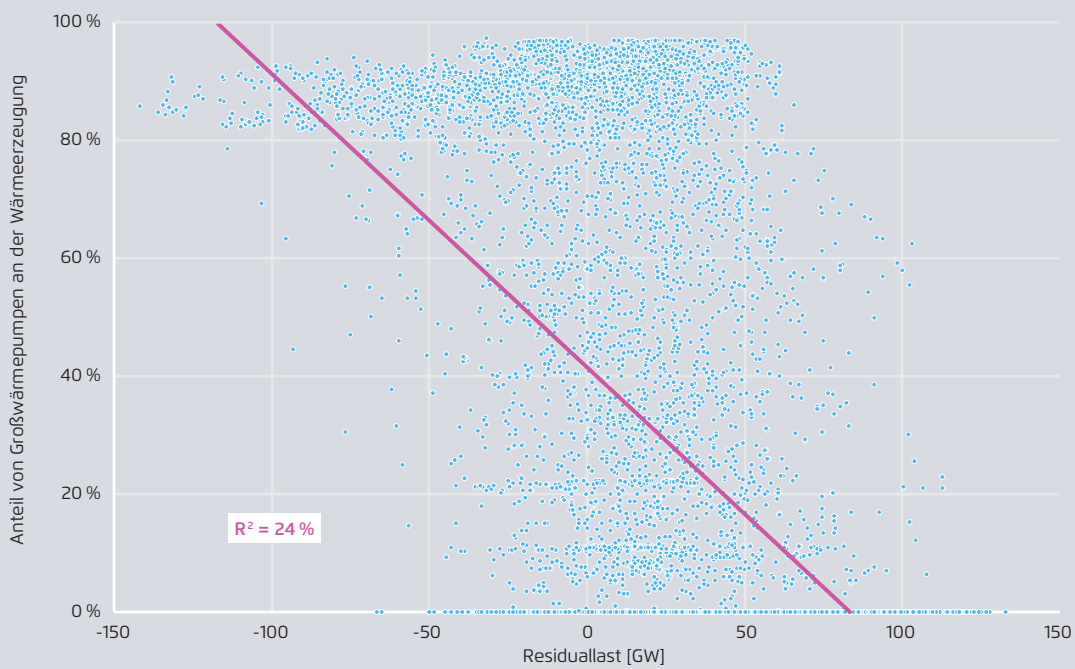
Anteil der Großwärmepumpe an der Wärmeerzeugung in Abhängigkeit von der Residuallast
